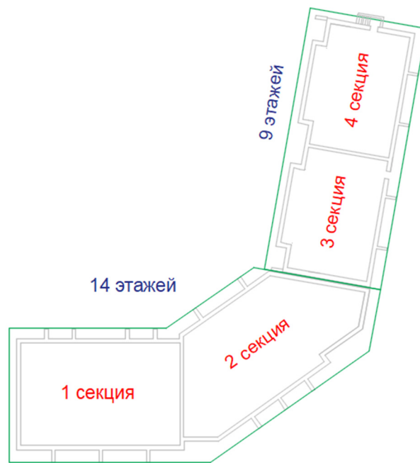
Рис.1 РАСПОЛОЖЕНИЕ СЕКЦИЙ ЗДАНИЯ
