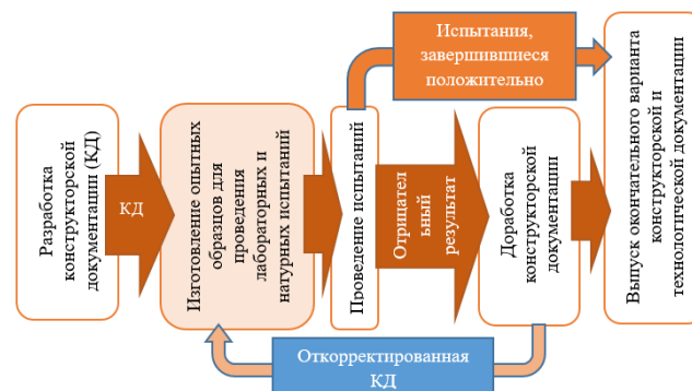
Рис. 1 Схема этапов изготовления изделий МОП
